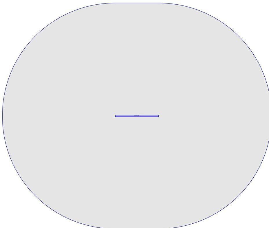
Area di raccolta fulmini della struttura,  $A_d$  **22 155.00 [m<sup>2</sup>]**
