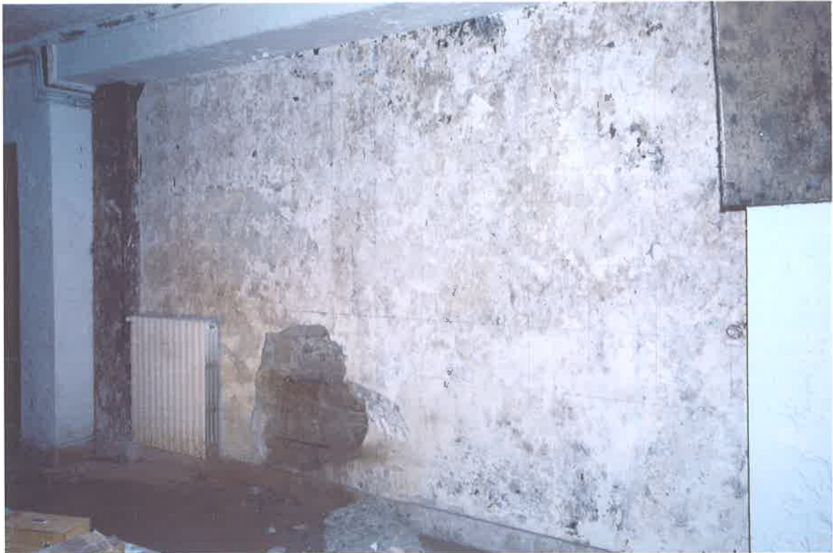
Foto 1 – Prova con martinetto piatto MD1 – Parete canonica
