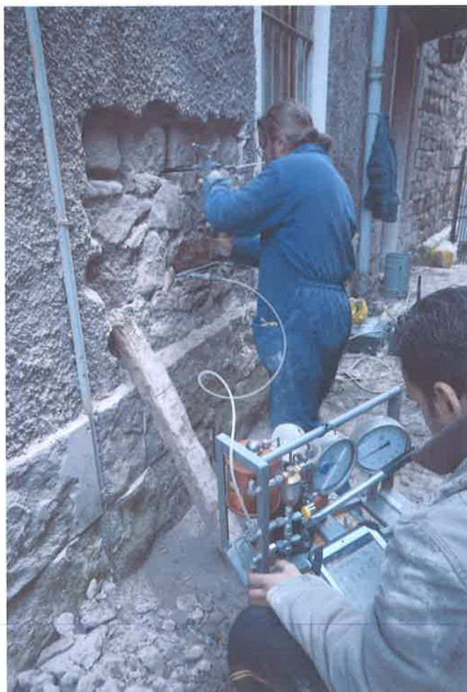
Foto 6 – Prova con martinetto piatto MD2 – Esterno. Esecuzione prova
