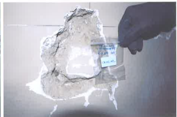
Foto 06. Prelievo campione intonaco CH02INT
