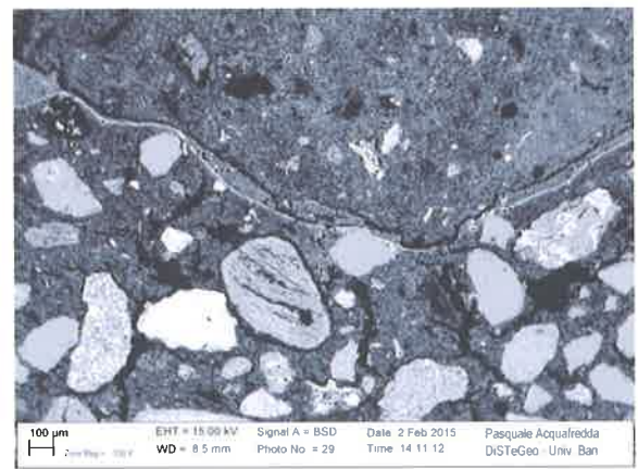
Figura 16: CH03INT, immagine BSE (SEM) del contatto fra lo strato C (in alto) e strato A (in basso).
