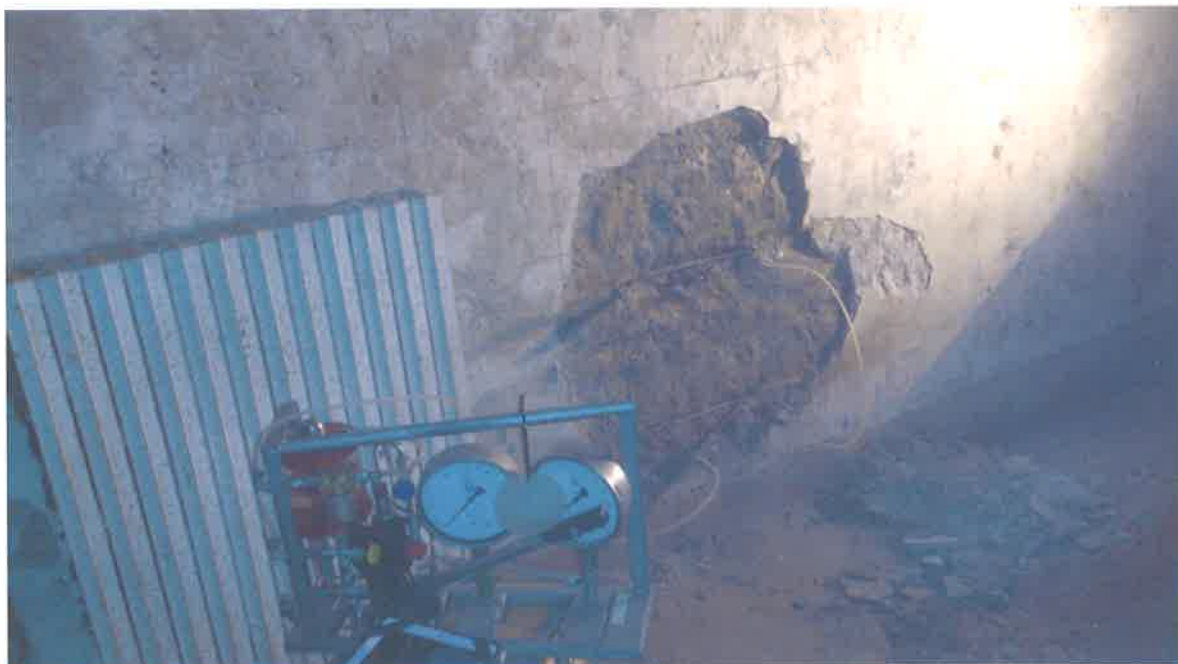
Foto 3 – Prova con martinetto piatto MD1 – Canonica. Esecuzione prova
