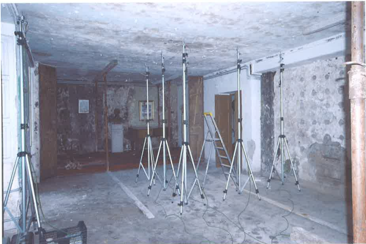
Foto 01 – Posizionamento Sensori S1 – S6. Piano terra Canonica
