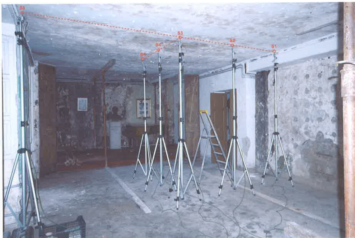
Fig. 1 – Posizionamento Sensori S1 – S6
