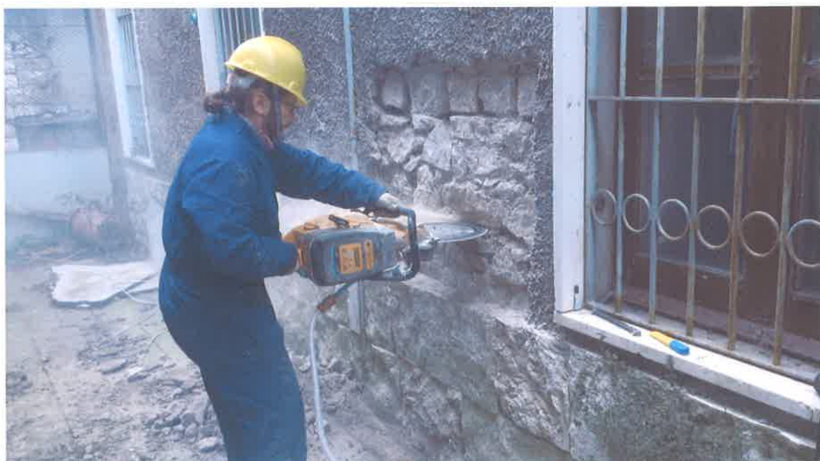
Foto 4 – Prova con martinetto piatto MD2 – Esterno. Fase di taglio
