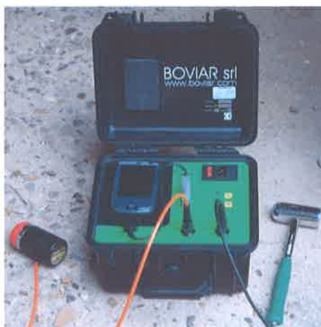
Centralina di acquisizione mod. CMS con palmare, ricevitore piezoelettrico RSG-55 e martello strumentato.
