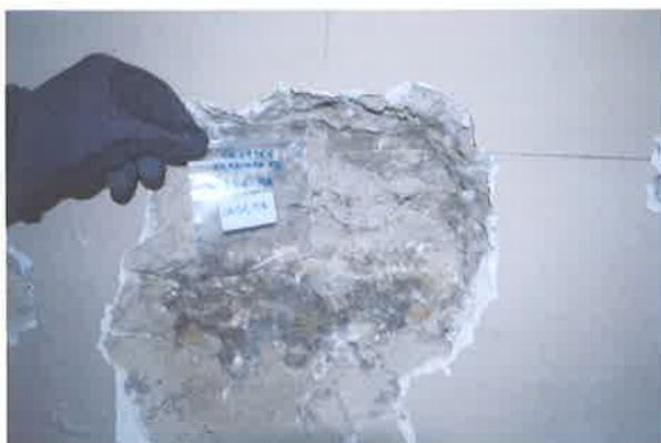
Foto 05. Prelievo campione di malta CH01MA
