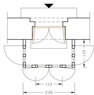
**Progetto della nuova bussola d'ingresso con aperture verso l'esterno ed eliminazione delle barriere architettoniche**
